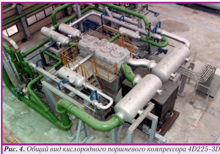
**Рис. 4.** Общий вид кислородного поршневого компрессора 4D225-3D
