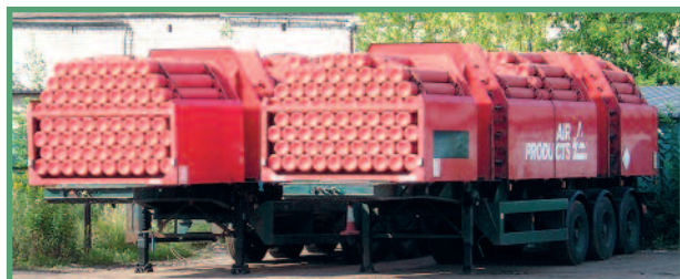
Фото 5. Полуприцепы для перевозки компримированного водорода
