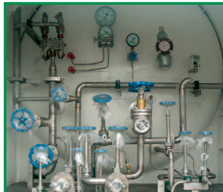
Фото 5. Размещение арматуры и приборов в отделении управления полуприцепа
