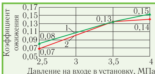
Рис. 3. Зависимость коэффициента ожижения от давления на входе в установку: 1 — с учётом изменения КПД детандера; 2 — без использования регулирования
