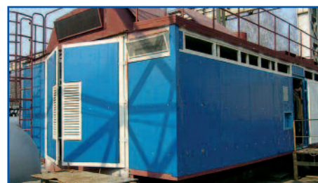
Фото 1. Оборудование АГНКС в процессе доводки в блоке испытательных стендов объединения
