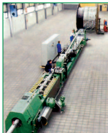
Фото 6. Вид технологической линии для изготовления криогенного трубопровода «Криофлекс» на машинах «Uniwema»
