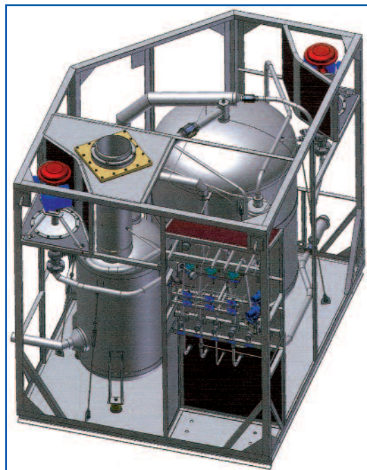
Рис. 2. Криогенный блок ожижителя ОПГ-3-3-0,6
