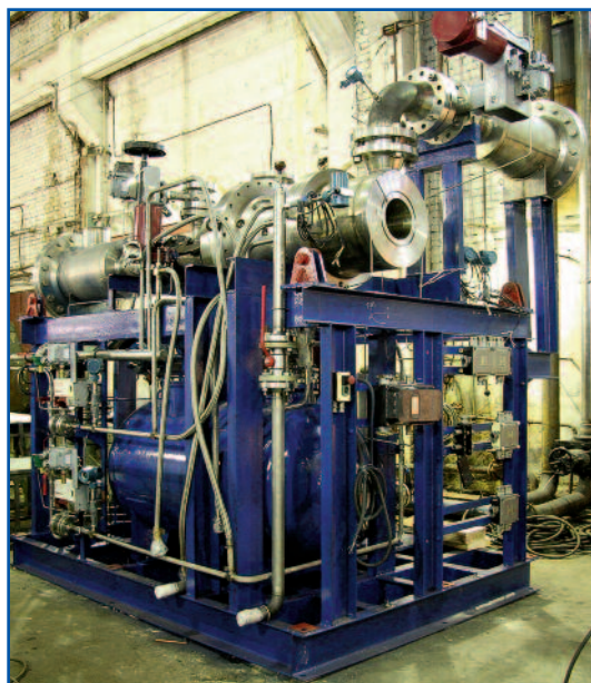
Фото 3. Аппарат турбодетандер-турбокомпрессор ожижителя ОПГ-3-3-0,6
