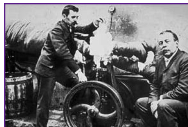
Фото 13. Клод (слева) демонстрирует Делорму детандер, созданный им для работы в составе его ожижителя (1902 г.)
