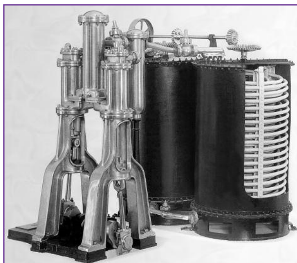
Фото 4. Первая коммерческая холодильная машина Линде, работавшая с 1877 г. на пивоваренном заводе в Триесте (Италия)
