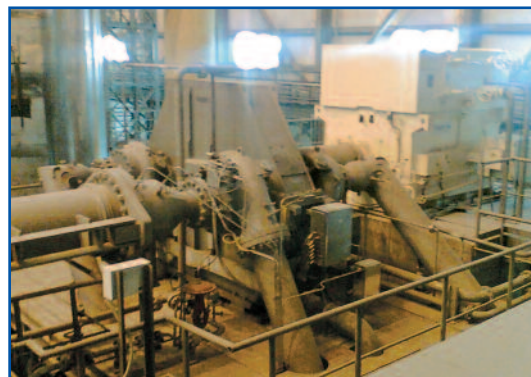
Фото 8. Внешний вид бустер-компрессора С05
