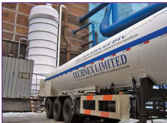
**Фото 9.** Полуприцеп украинской сборки заправляется жидким аргонem для проведения ходовых испытаний, отработки технологий заправки криопродуктами и их слива в стационарные криогенные резервуары
