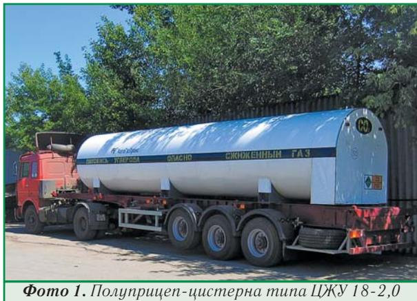
**Фото 1.** Полуприцеп-цистерна типа ЦЖУ 18-2,0
