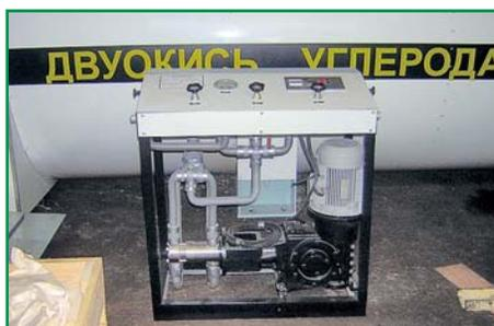
**Фото 5. Углекислотозарядная станция типа АГТ 24АД**
