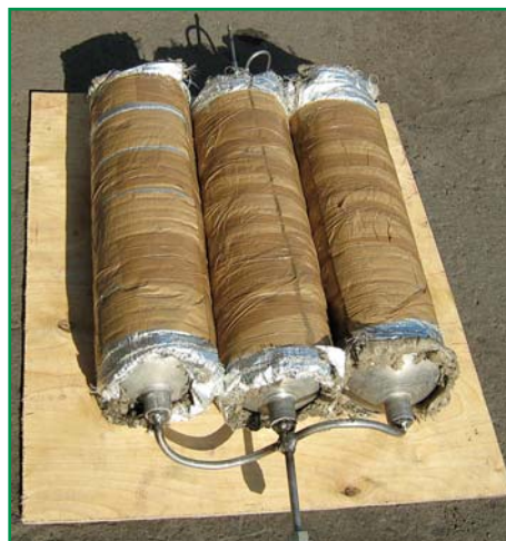
Фото 1. Подготовка лейнеров для их заливки пеноизоляцией
