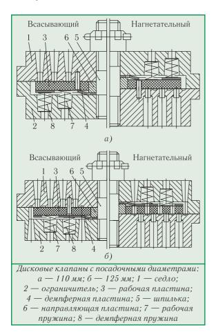
При длительной эксплуатации было установлено, что в клапанах IV ступени более часто ломаются пластины, что вызывает остановки всей установки.
