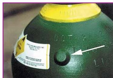
**Фото 9.** RFID tag «Trovan», закреплённый на «плече» баллона компании «Praxair»
