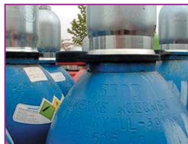
**Фото 8.** RFID tag «Scemtec», закреплённый на кольце баллона компании «Messer»
