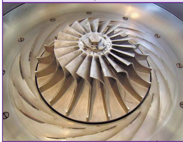
Рис. 7. Модель с программой для станка с ЧПУ (а) и изготовленное рабочее колесо (б)
