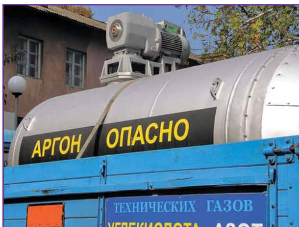
Фото 16. Возле гостиницы, где проводился семинар, находился автомобиль ПКФ «Криопром» ООО с установленной на нём криогенной цистерной. На цистерне размещён привод и механизм движения погружного жидкостного криогенного насоса. С помощью этого насоса можно заправлять баллоны европейского производства продуктами разделения воздуха до давления 200 кгс/см 2 и даже более высокого
