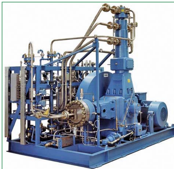
Фото 16. Трехступенчатый гибридный дожимающий компрессор компании «Andreas Hofer Hochdrucktechnik GmbH» производительностью 500 \text{м}^3/\text{ч} и с давлением нагнетания 30 МПа
