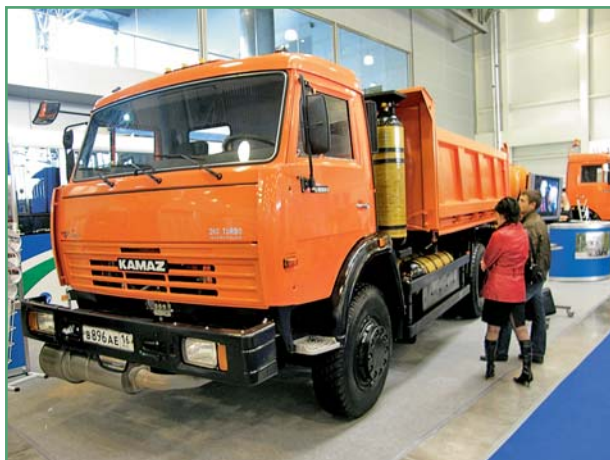
Фото 6. Автомобиль КАМАЗ модели 65115, оснащенный газовым двигателем 820.60-260 с турбонаддувом и газотопливной системой 4-го поколения
