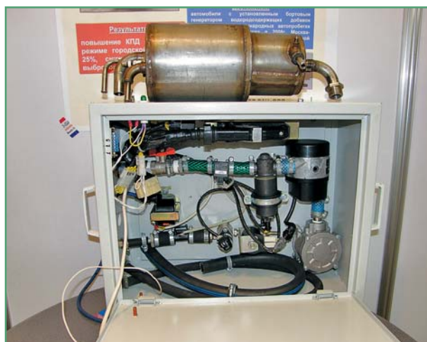
Фото 4. Генератор синтез-газа и модуль микропроцессорной системы управления, демонстрируемые на стенде «РФЯЦ-ВНИИЭФ»
