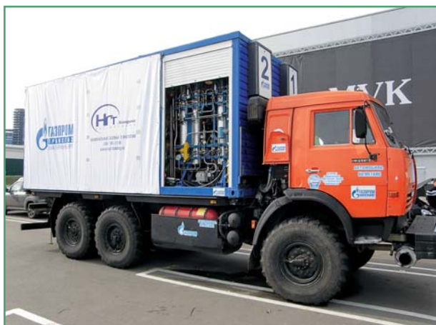
Фото 11. Внешний вид ПАГЗ 1200К на шасси КАМАЗ с дожимающим компрессором и блоком аккумуляторов объёмом 1200 нм 3 на стоянке перед ВЦ «Крокус Экспо»
