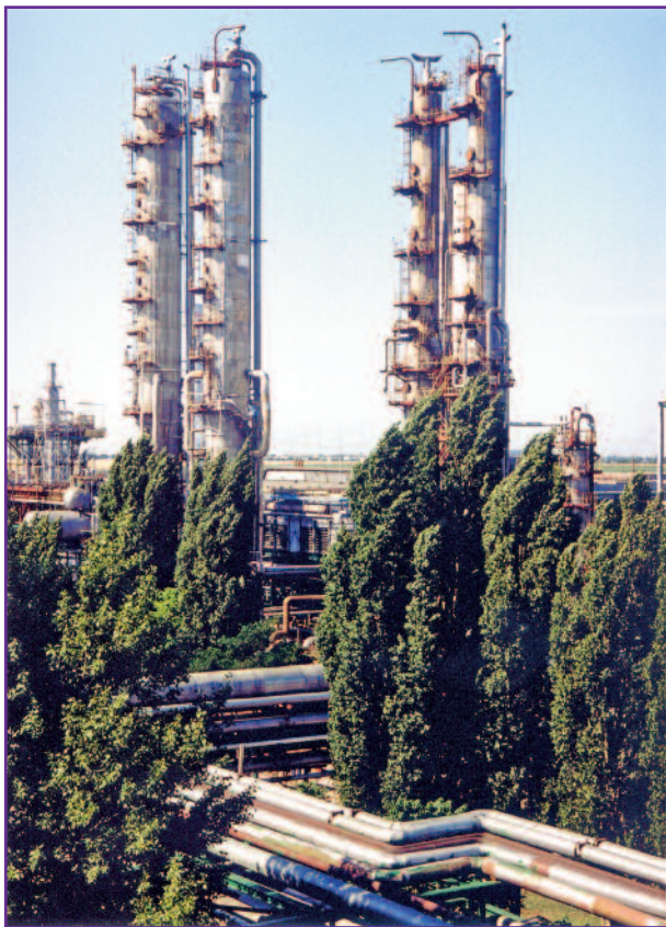
Фото 4. Адсорберы и регенераторы системы очистки азотоводородной смеси от диоксида углерода ОАО «Одесский припортовый завод»
