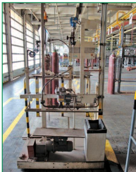
**Фото 5.** Установка для автоматического ацетонирования ацетиленовых баллонов
