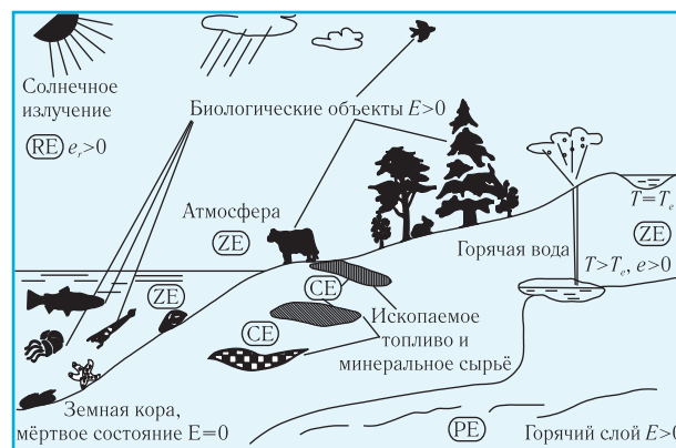
Рис. 6. Обобщённая схема природной окружающей среды и её компонентов: ZE — нулевая эксергия (природная среда); CE — химическая эксергия; RE — эксергия солнечного излучения; PE — эксергия горячих подземных областей
