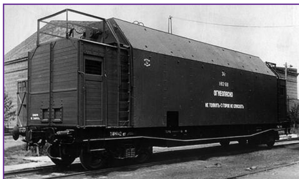
Фото 1. Железнодорожная цистерна модели 8Г52 для транспортирования и заправки жидким кислородом ракет-носителей Р-1, Р-2
