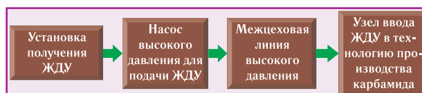
Рис. 3. Принципиальная схема использования жидкого диоксида углерода в узле синтеза производства карбамида АК-70 (при небольшом расстоянии между установками)
