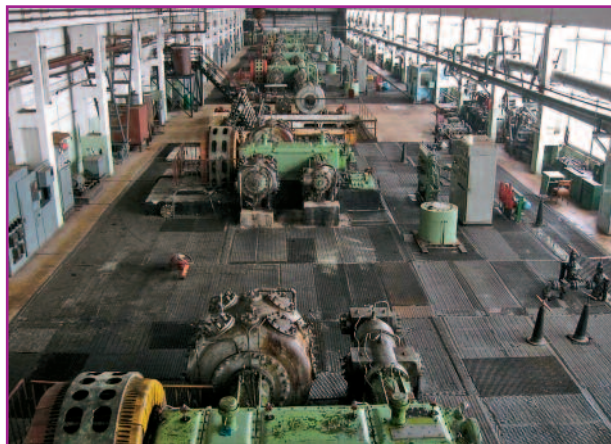
Фото 1. Поршневые компрессоры для подачи газообразного \text{CO}_2 в агрегаты получения карбамида
