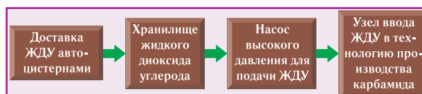
Рис. 2. Принципиальная схема использования жидкого диоксида углерода в узле синтеза производства карбамида АК-70 (при большом расстоянии между установками)
