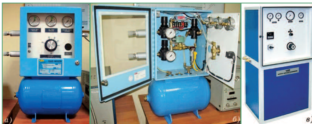
Фото 5. Внешний вид (а) и устройство (б) поточного смесителя марки 8500CA50X2100 фирмы «Thermo Instrument Corporation»; внешний вид смесителя марки MG 200-2ME/3ME фирмы «WITT-Gasetechnik» (в)
