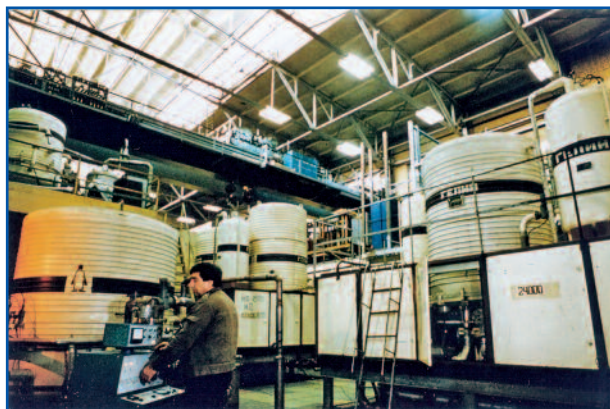
Фото 4. Оборудование ожижителя ОГ-800 во время испытаний в ИАЭ им. Курчатова
