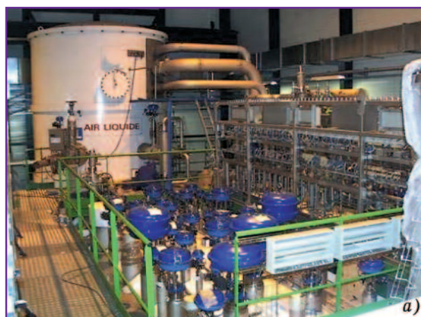
Фото 13. Транспортабельный модуль ожижителя гелия ОГ-2400
