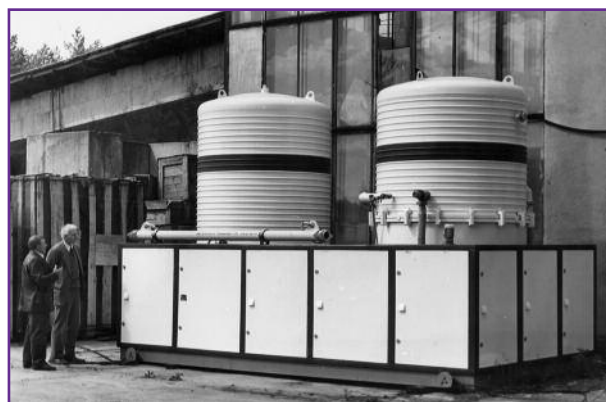
Фото 13. Транспортабельный модуль ожижителя гелия ОГ-2400
