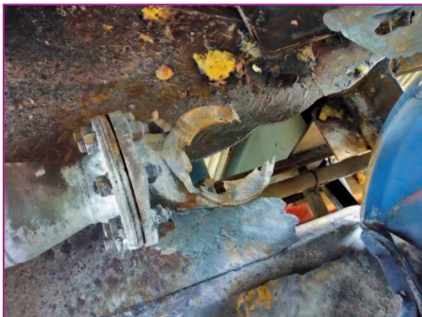
Фото 9. Результаты загорания клапана в линии газообразного кислорода под давлением
