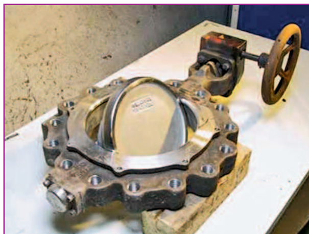
Фото 11. Аналог аварийного клапана. Штурвал крепится к валу редуктора с помощью винта
