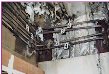
Фото 6. Загорание трубопроводов корабельной гидросистемы
