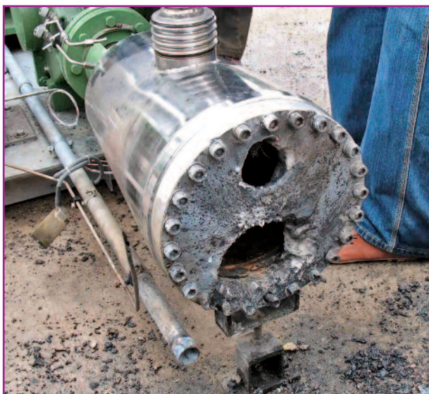
Фото 3. Корпус насоса жидкого кислорода после инцидента
