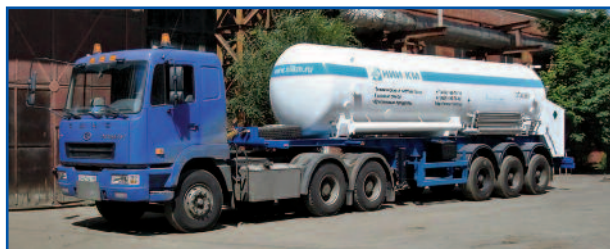
Фото 3. Полуприцеп-заправщик для транспортирования жидких криопродуктов ёмкостью 16 м 3 — совместная разработка НТК «Криотехника» (г. Омск) и ООО «НИИ КМ»
