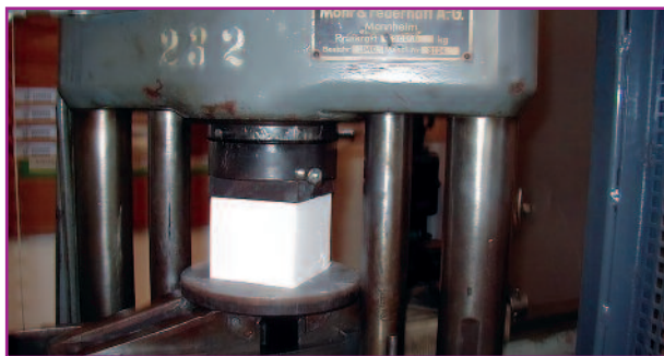
Фото 9. Испытание на прочность пористой массы А-10W ECO
