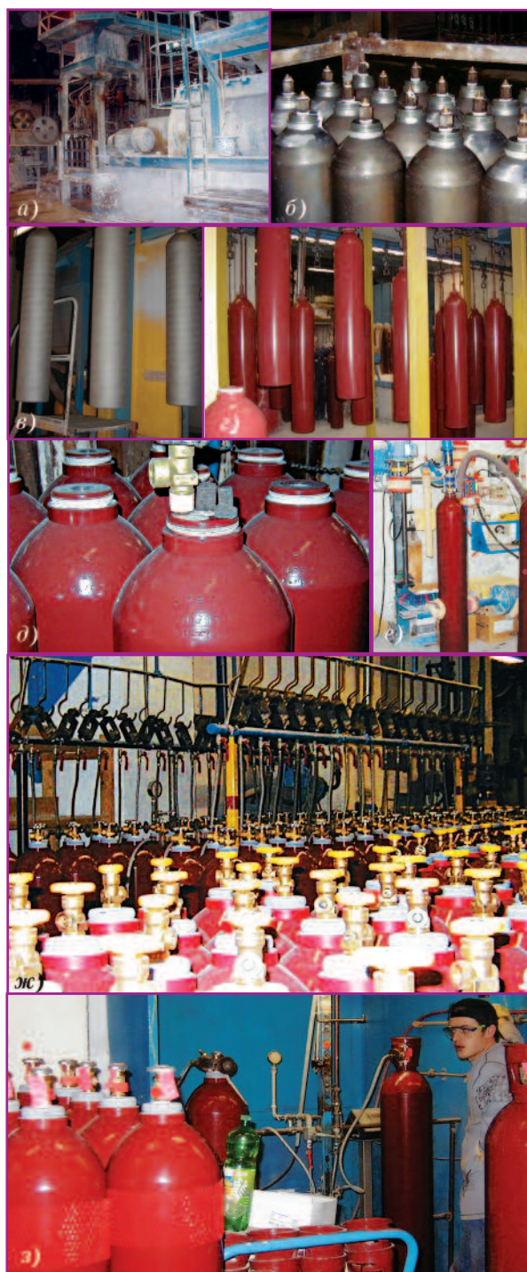
Фото 2. Процессы подготовки ацетиленовых баллонов в компании «Worthington Cylinders GmbH»: а — наполнение баллонов пористой массой; б — термообработка баллонов в автоклаве; в — дробеструйная обработка внешней поверхности баллонов; г — порошковая покраска баллонов; д — установка фильтров; е — монтаж вентиля баллона; ж — вакуумирование баллонов; з — участок заполнения баллонов растворителем (ацетоном или ДМФ)
