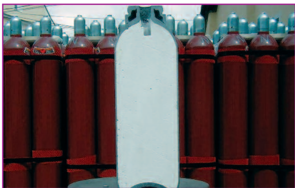
Фото 8. Ацетиленовый баллон Worthington в разрезе
