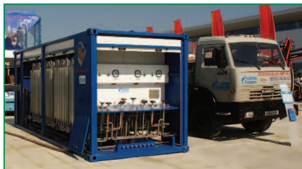
Рис. 4. Газификатор с атмосферным испарителем криопродуктов типа «Гелиос-240/40» в транспортном исполнении
