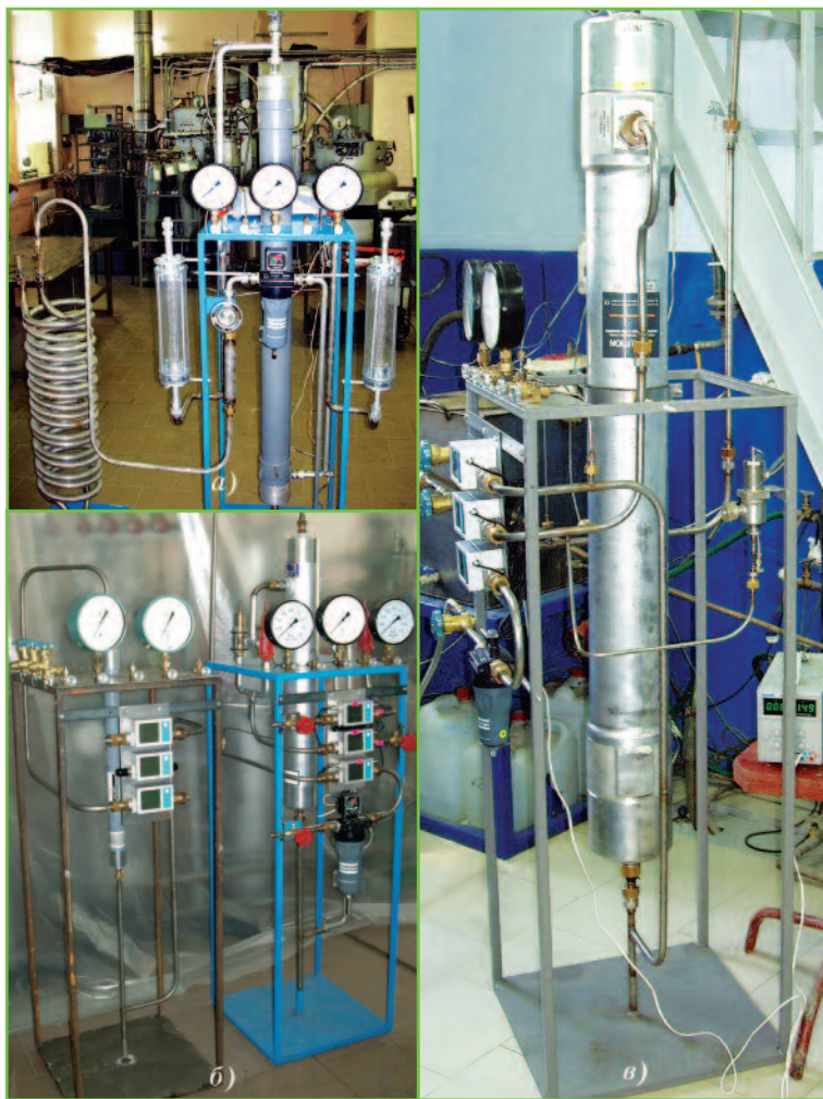
Рис. 10. Экспериментальные стенды для исследования характеристик азотных мембранных модулей на Ne-He-N 2 — смеси и чистых компонентах: а) — «Air Products»-PA4050-РЗ; б) — «Generon 210» и «Generon 4100»; в) — «Air Products» -PA6050N1
