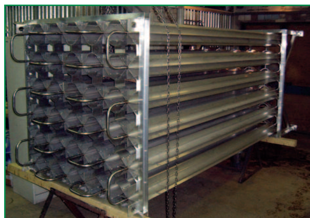
Фото 3. Гидравлическое испытание испарителя ИВ-0350-С
