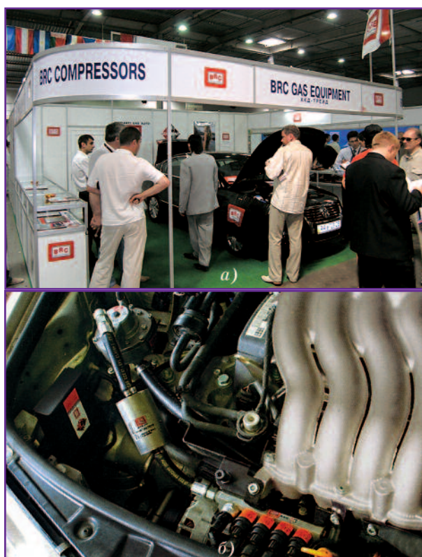
Фото 4. Специалисты знакомились на выставке «Мир сжиженных и сжатых газов» (г. Киев) с автомобилем, оснащенный системой многоточечного впрыска газа (а), и подробно изучали элементы и комплектацию системы «Sequent Fastness» (б)
