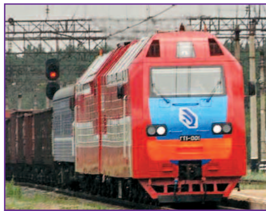
Фото 7. Газотурбовоз ГТ1-001 в процессе ходовых испытаний
