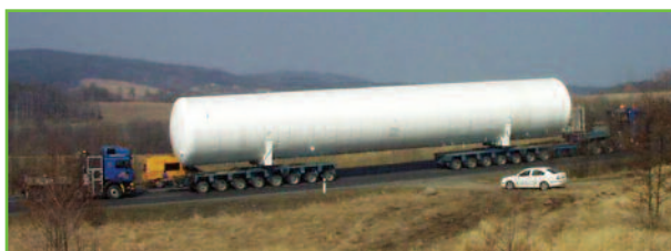
Фото 4. Горизонтальная вакуумно-изолированная ёмкость для СПГ объёмом 500 м 3 при её доставке по автодороге
