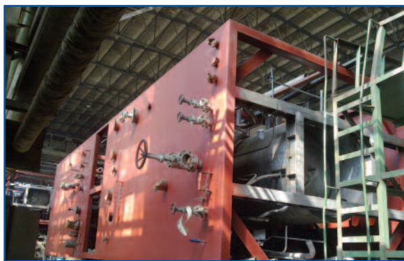
Фото 3. Один из блоков модульного исполнения для ВРУ производительностью 10 тыс. м 3 /ч технического кислорода
