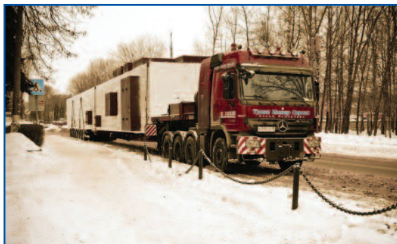
Фото 2. Холодный блок установки разделения воздуха высотой 35 м
