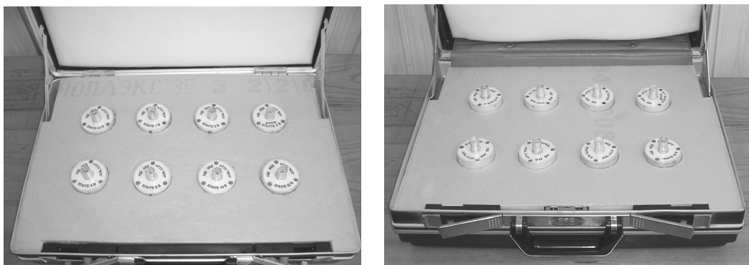
Рис. 14. Внешний вид комплекта эталонных (слева) и переносных (справа) преобразователей напряжения термоэлектрических, разработанных в НИИ АЭИ НТУУ “КПИ”.
