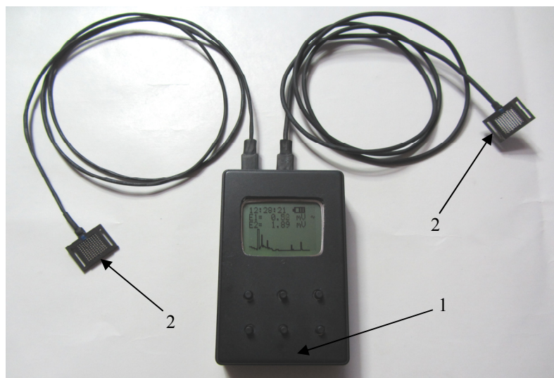
Рис. 1. Модернизированный прибор для измерения тепловых потоков человека: 1 – электронный регистратор, 2 – термоэлектрический сенсор теплового потока и температуры.
