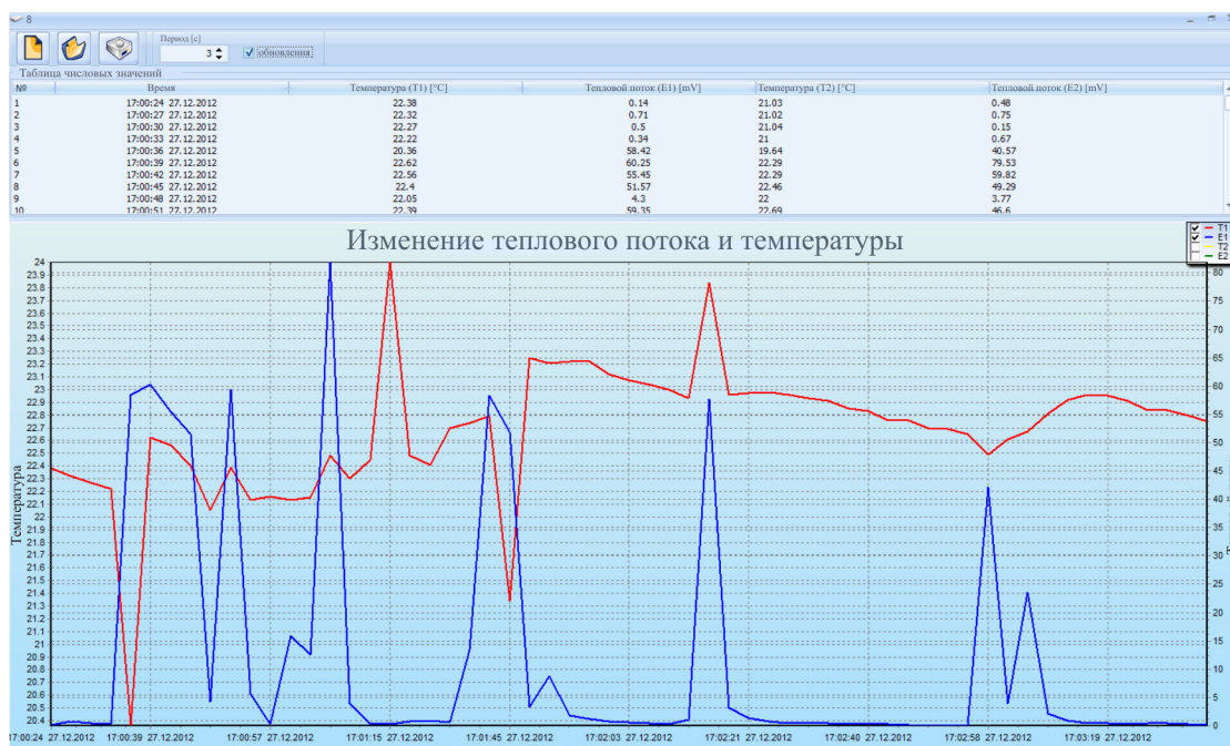
Рис. 4. Интерфейс компьютерной программы "Termomonitor" для обработки данных из электронного регистратора, их накопления и воспроизведения в заданном виде на персональном компьютере:
