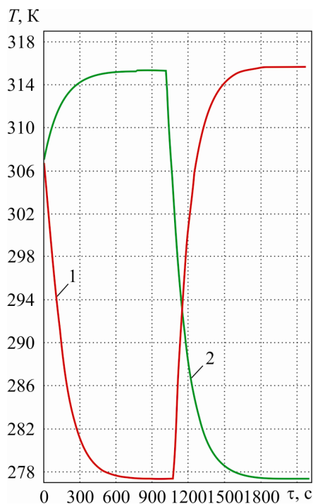
Рис. 13. Изменение температуры биологического объекта во времени при контрастных процедурах для q_{ТЭБ,о} = 4000 \text{ Вт/м}^2 , q_{ТЭБ,н} = 1200 \text{ Вт/м}^2 . 1 – охлаждение-нагрев, 2 – нагрев-охлаждение.
