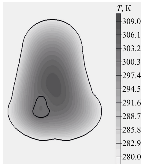
Рис. 4. Двумерное температурное поле сечения средней трети плеча в стационарном режиме при охлаждающем воздействии для q_{ТЭБ} = 2500 \text{ Вт/м}^2 .
