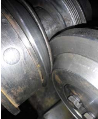
Рис. 3. Механізм для гнуття полицки на гвинтовій спіралі
