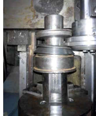
Рис. 3. Механізм для гнуття полицки на гвинтовій спіралі
