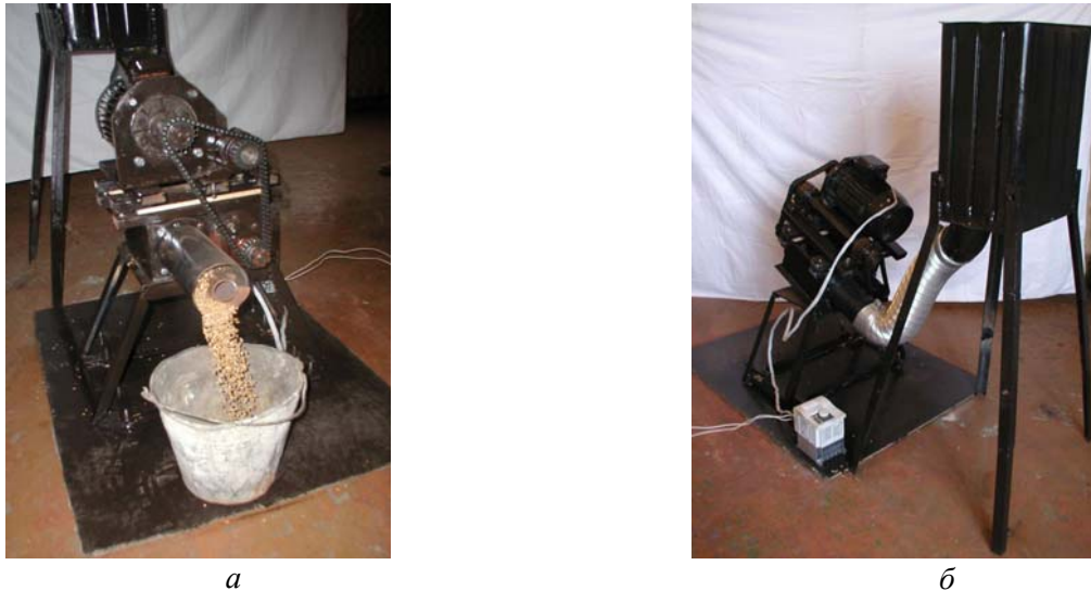
Рис. 1. Загальний вигляд перевантажувального патрубку: а – в горизонтальному положенні; б – в похилому положенні
