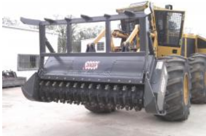
Рис. 3. Навісний мульчер Nokatic з гідроприводом (Канада)
