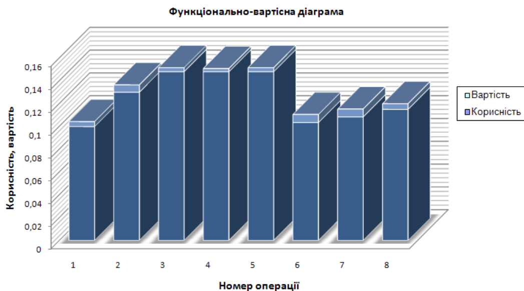
Рис. 1. Функціонально-вартісна діаграма процесу приготування комплексних преміксів: 1 – попередня підготовка сировини; 2 – подача домішок; 3 – подрібнення; 4 – просіювання; 5 – змішування; 6 – вивантаження; 7 – фасування; 8 – пакування
