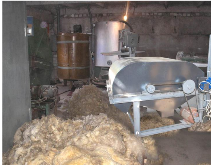
Рис. 1. Малогабаритна тріпальна машина МТ-001А-12 у складі технологічного модуля первинної обробки вовни ТМ ПОВ-8,0
