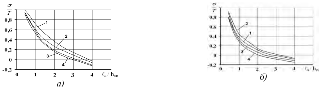
Рис. 2. Зависимость показателя напряженного состояния \sigma/T от коэффициента формы l_D / h_{cp} при вальцовке заготовок при температуре 420°C (а) и 470°C (б) из сплава: 1 – АМГ; 2 – АК6; 3 – АК8; 4 – АМЦ
