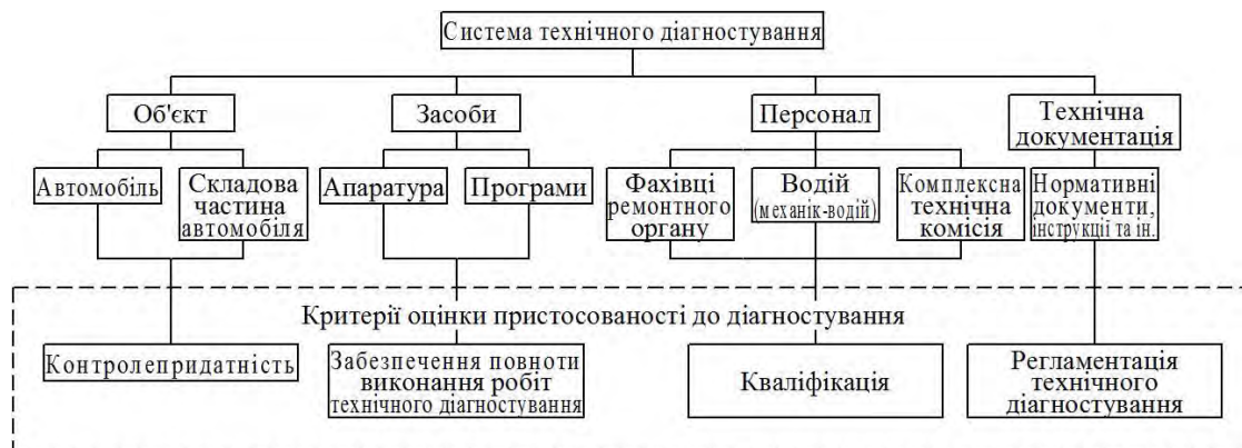
Рис. 1. Складові системи технічного діагностування автомобілів в сільському господарстві
