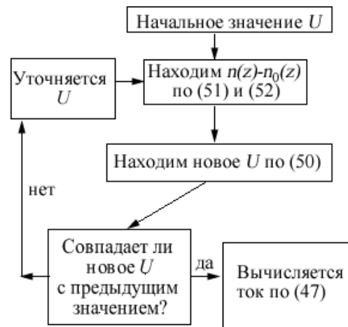
Рис. 22. Самосогласованная процедура вычисления потенциала проводника U и тока в расширенной модели проводника
