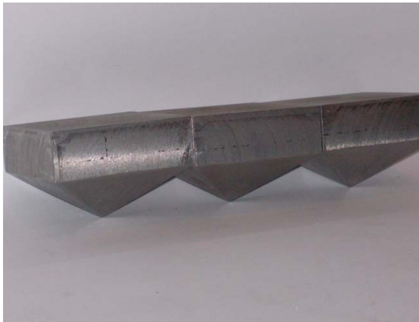
Рис. 1. ФЭМ квадратной формы с пирамидальным основанием
