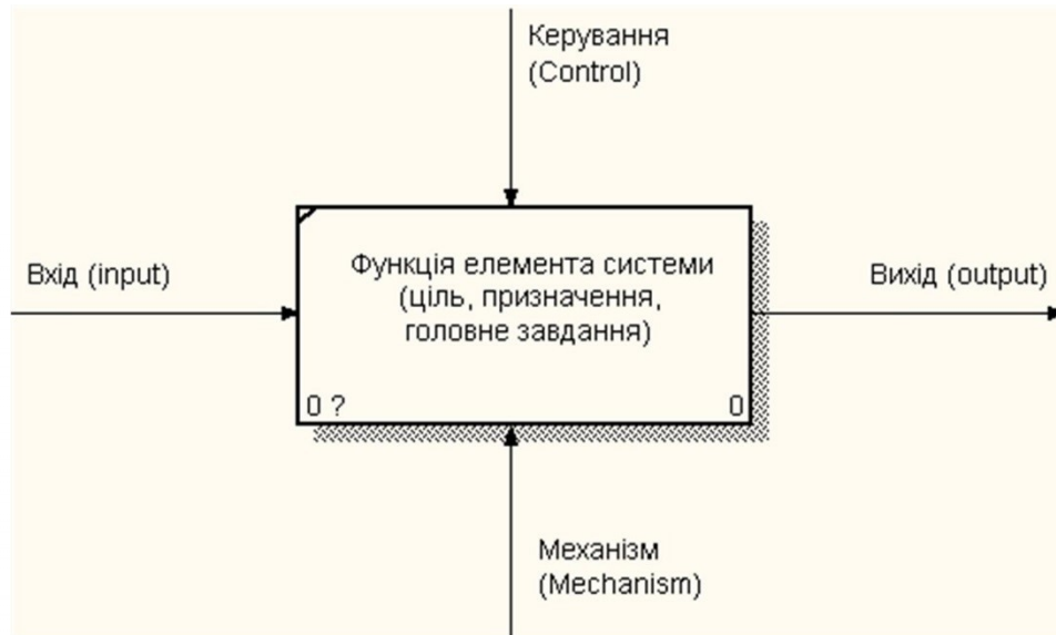
Рис. 1 Приклад функціонального блока моделі IDEF0
