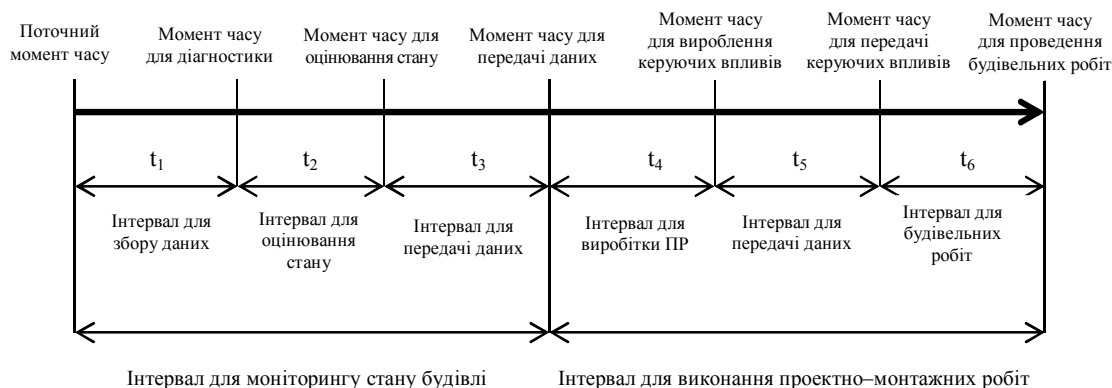
Рис. 1. Моніторинг енергоощадності муніципальних будівель: а – схема моніторингу енергоощадності будівель; б – часовий графік енергомоніторингу та реконструкції будівель
