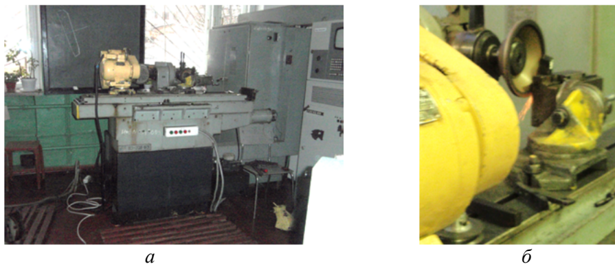
Рис. 12. Шліфування твердосплавної пластини на верстаті моделі В3208Ф3
