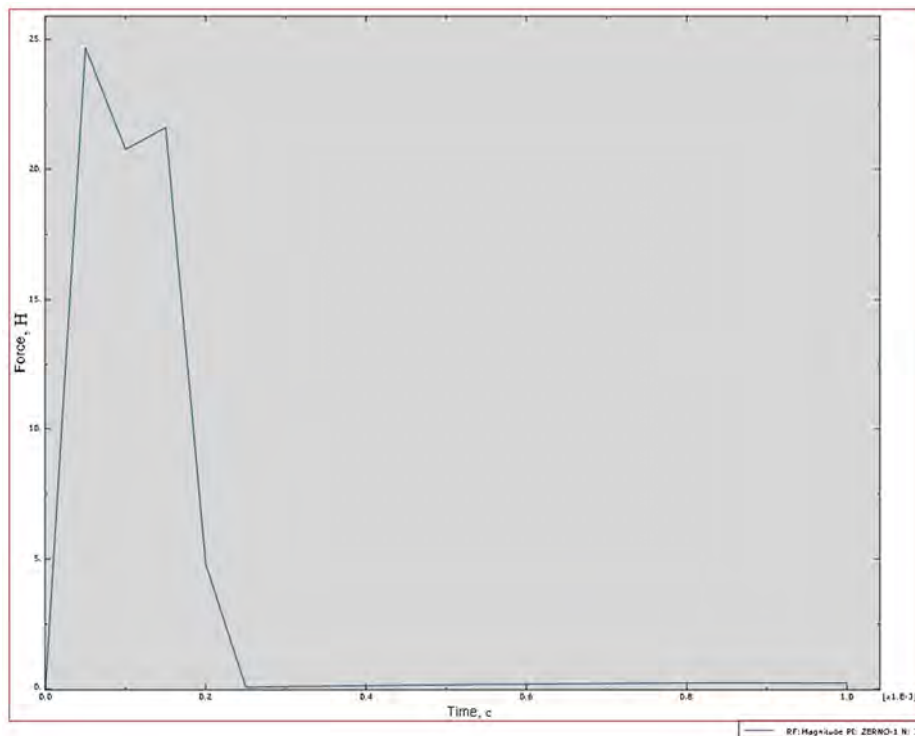
Рис. 9. Залежність часу від сили різання абразивного зерна в точці 3
